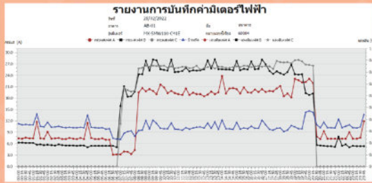
ตัวอย่างรายงานค่ากระแสไฟและแรงดัน
